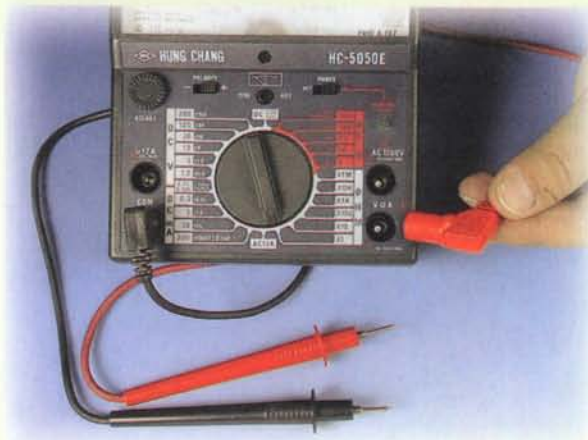
Figura 3.4. Colocación de las puntas de prueba
